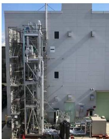
図 3.ヒートポンプ式アンモニア回収装置
