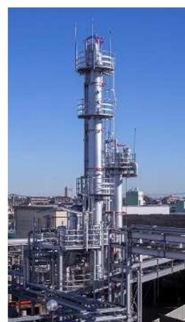
図 4.省エネ型ヒートポンプ式蒸留装置
