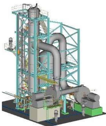
図 1.MVR 型蒸発装置
