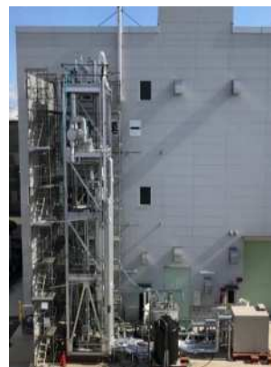
図 3. ヒートポンプ式アンモニア回収装置 (テスト装置 当社尼崎工場内に設置)
