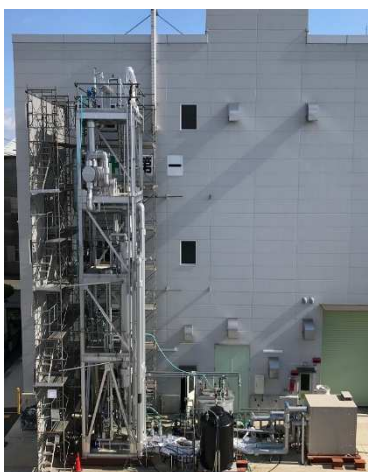
図 3.ヒートポンプ式アンモニア回収装置 (テスト装置 当社尼崎工場内に設置)
